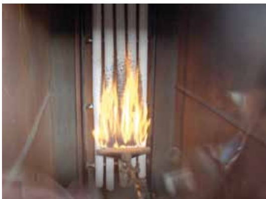
Zkouška nátěru PROMASTOP ® , typ K
