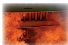
Ve dnech 6. a 15. 9. 2011 proběhl ve zkušebně ve Veselí požár dvoupodlažního objektu pod taktovkou prof. Františka Walda (ČVUT Praha). Cílem bylo prokázat chování nosních konstrukcí a různých typů obvodových pláštů při požáru. Na více informací si sice budeme muset počkat, nicméně nástřík PROMASPRAY® F250 fungoval bezvadně a jím chráněné části OK se ani nehnuly.
